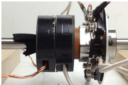
図 5 回転型非接触給電トランスの軸への取り付け
